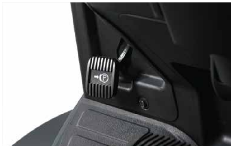
Kényelmesen, lábbal működtethető rögzítőfék
