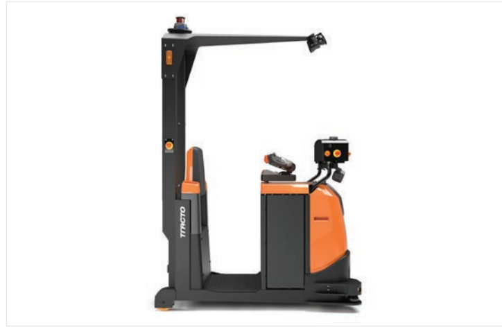
Az ismétlődő munkafázisokat a gyártósoroknál és tároló területeknél, illetve a szállítószalagoknál az Autopilot TAE500-as automata vontatótargoncák veszik át.
