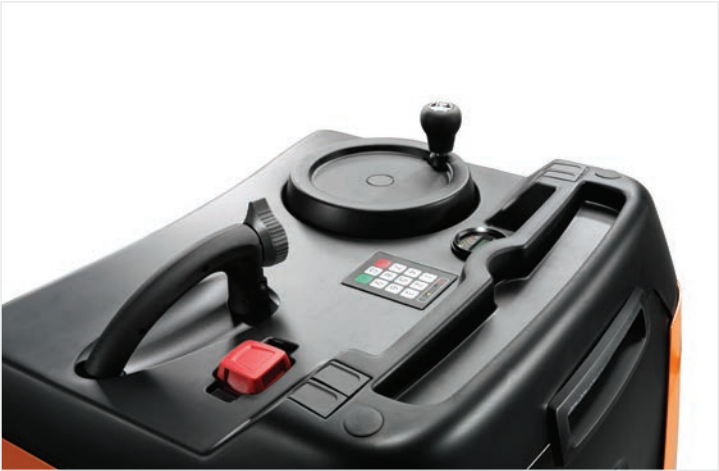
Kisméretű kormánykerék és PIN-kódos hozzáférés
