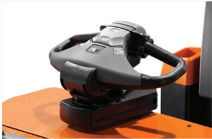
E-man vezérlőrendszer, amely a targonca mindkét oldalára elmozdítható, és így megkönnyíti a „gyalogosan kísért” használatot
