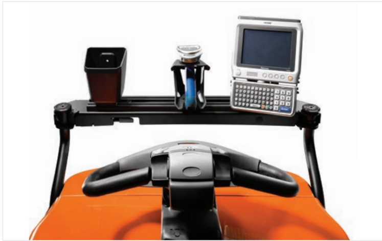
E-bar tartósín, amely raktártechnikai tartozékok (vonalkódolvasó, PC) csatlakoztatására szolgál akár elektromos csatlakozóval
