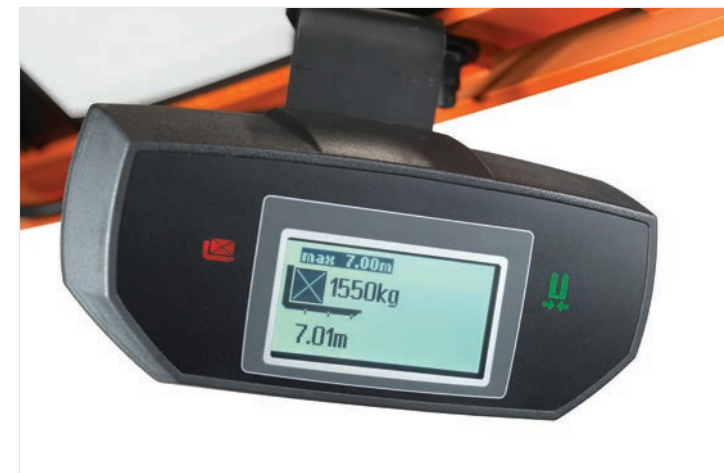
Túlerhelésre figyelmeztető rendszer jelzést ad a gépkezelőnek, amikor az emelt rakat tömege elérte az emelési magassági határt.
