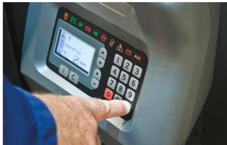
A BT Access Control hozzáférés-szabályozó funkció megelőzi a gép illetéktelen személyek általi használatát, és lehetővé teszi az egyes gépkezelők személyes paramétereinek beállítását a targonca indításakor
