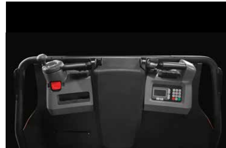
Az ergonomikus osztott vezérlő egységek teljes hozzáférést engednek a gépkezelőnek a palettán lévő áruhoz.
