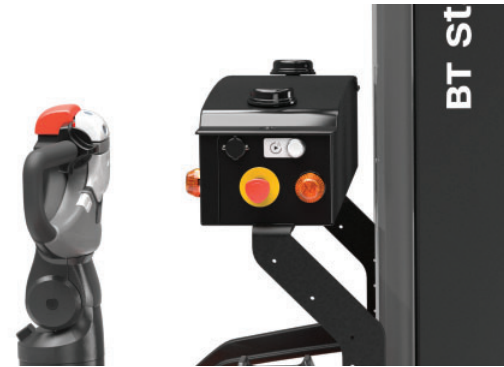
A vészleállító gombok a kezelők által könnyen elérhető helyen vannak
