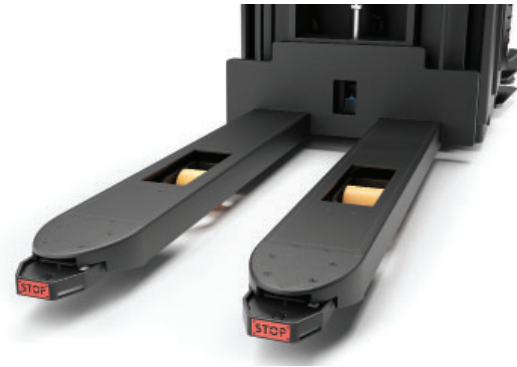
A mechanikus ütközők a villahegyen keskeny folyosókon való haladás közben fokozzák a biztonságot
