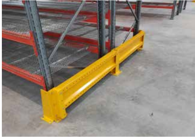
Az oszlop- és keretvédők megakadályozzák a sérüléseket az állványrendszeren
