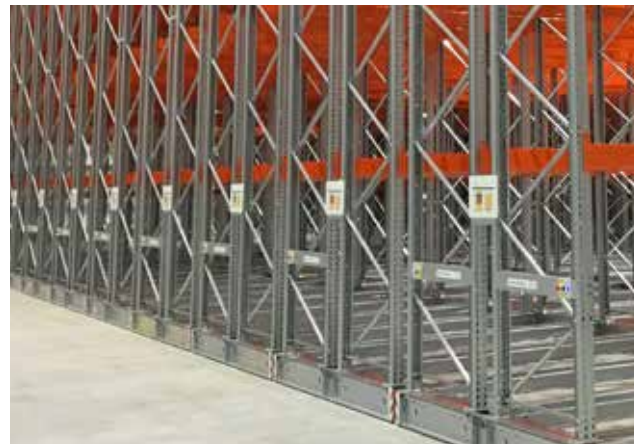
Az állványrendszer külső oldalán lévő vészleállító gombokkal vészhelyzetben azonnal leállítható a mozgó állványrendszer.
