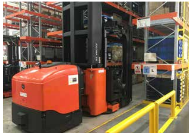
A folyosó végeire felszerelt konzolos átadó állomásokon (P&D állomás) veszik fel vagy készítik ki az árukat.
