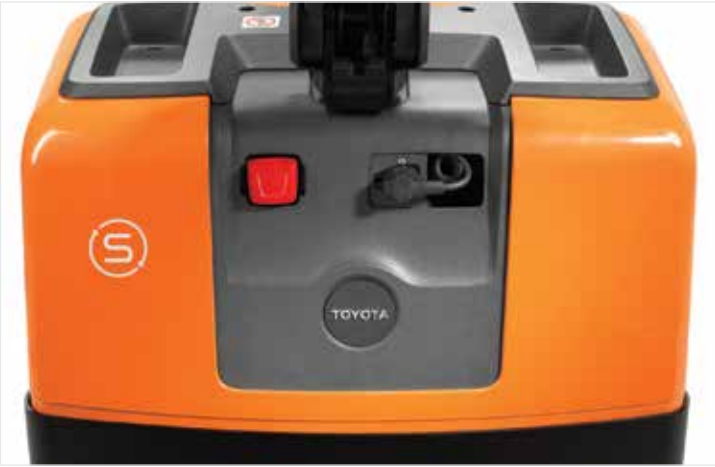
A vezérlőpanelen a beépített akkumulátortöltő kihúzható tápkábele is helyet kapott
