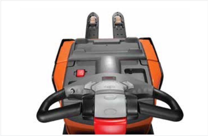
Akadálymentes rálátás az emelővillákra a vezetőállásból
