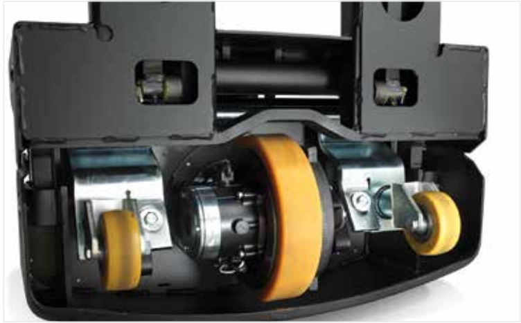
Egyetlen felületen az egyedülálló Castorlink rendszer gondoskodik a futógörgők védelméről
