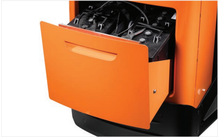
Gyors és egyszerű akkumulátorcsere
